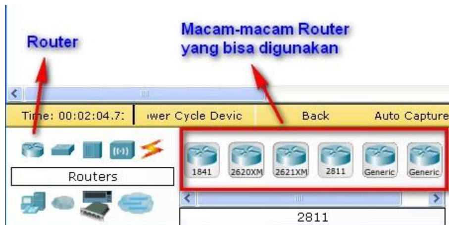
Gambar 2 : Ini Router, pada bagian Router bisa diklik aja,,,terus untuk pilihan-pilihannya yang bisa digunakan sebelah kanan, penggunaannya bisa klik tahan dan tarik ke lembar kerja...
